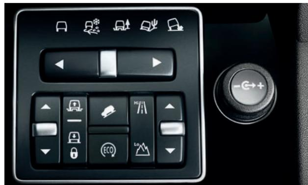
**Sistema Terrain Response® y Control de Liberación de Frenos en Pendiente**
