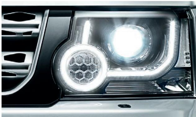
**Faros automáticos con cambio inteligente de luces largas a cortas y faros Xenon adaptativos con luces LED características**
